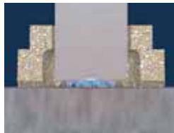
Der Bolzen wird unter Stromfluss abgehoben. Dadurch entsteht ein Lichtbogen.
